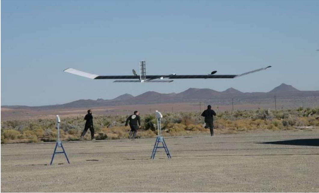
Fig. 4 – UAS con alimentazione a celle solari
